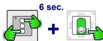
**3.B.2** - Appuyer simultanément sur Montée + Descente jusqu'au mouvement de va et vient du moteur.
